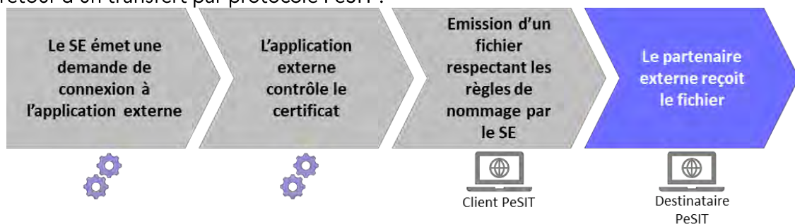
Figure 44 : Schéma d'un circuit retour d'un transfert par protocole PeSIT
