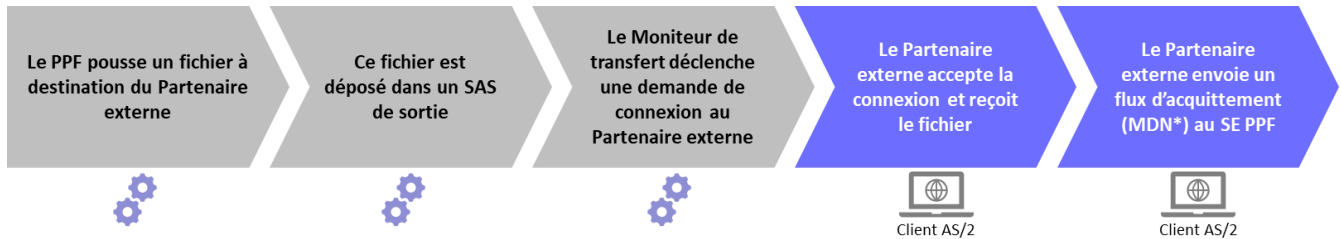
Figure 48 : Schéma d'un circuit retour d'un transfert par protocole AS/2
